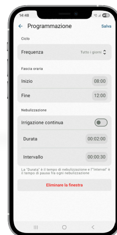
Finestra di programmazione, modalità nebulizzazione attivata.
