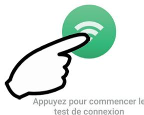
2/ Le message
